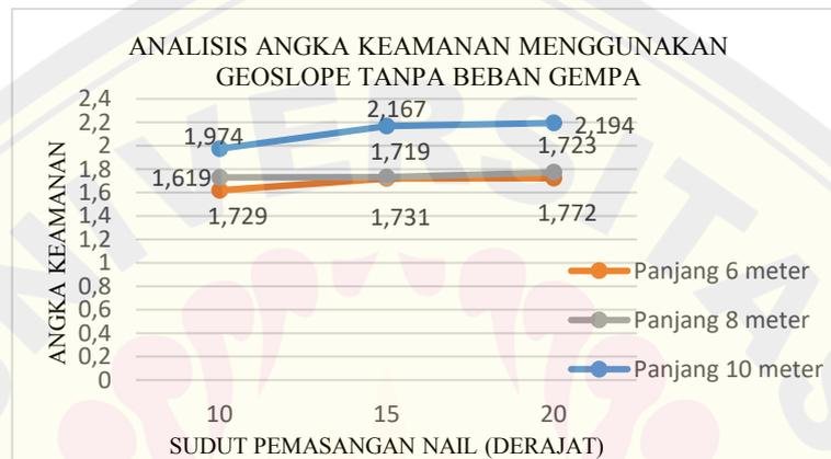
Gambar 4. 29 Grafik angka keamanan menggunakan *Geoslope* pada sudut pemasangan 10°, 15°, dan 20° tanpa beban gempa
