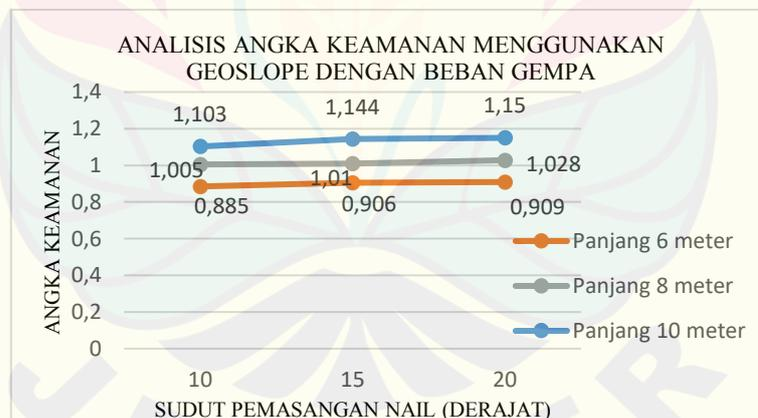
Gambar 4. 30 Grafik angka keamanan menggunakan *Geoslope* pada sudut pemasangan 10°, 15°, dan 20° dengan beban gempa
