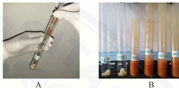
Gambar 2. A. Penuangan ekstrak kulit manggis ke dalam tabung perlakuan, B. Perendaman anasir gigi tiruan resin akrilik dalam aquades steril dan ekstrak kulit manggis.
