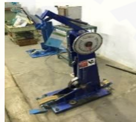
Gambar 4. Alat uji kekuatan impact metode Charpy
