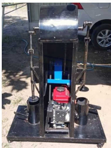
Gambar 2. Alat pengepres baglog 2 tuas Sehingga nilai kapasitas produksi baglog per hari (x) dengan waktu yang dibutuhkan untuk
