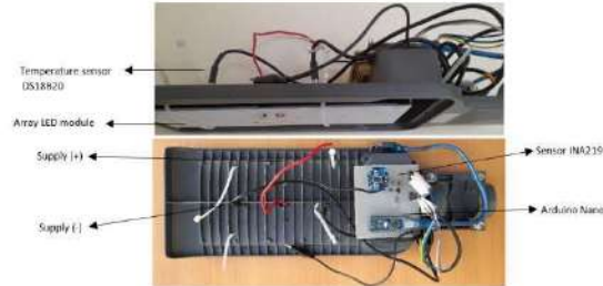
Fig. 3 Array LED PCB design (H : 20 ; V : 20)
