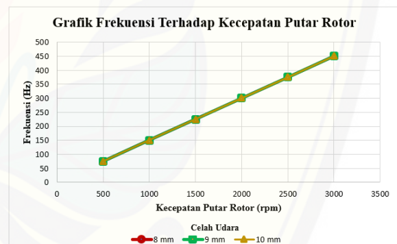
Gambar 11. Grafik frekuensi gelombang output generator terhadap kecepatan putar rotor pada variasi celah udara 8 mm, 9 mm, dan 10 mm
