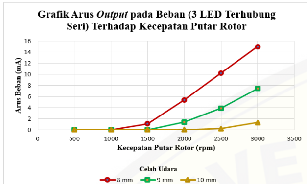
Gambar 14. Grafik arus output generator terhadap kecepatan putar rotor pada variasi celah udara 8 mm, 9 mm, dan 10 mm
