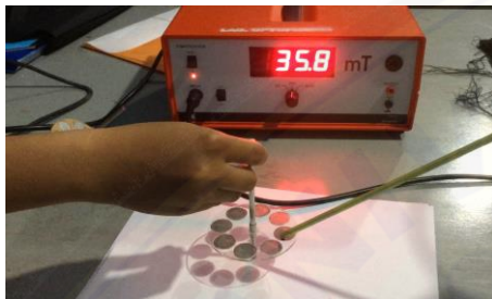
Gambar 3. Hasil pengukuran densitas magnet permanen 20mm x 2mm
