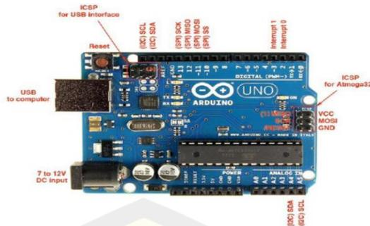
Gambar 2. 8 Modul Mikrokontroler *Arduino Uno*
