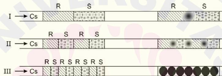
Gambar 2. 5 *Multi-Commutation* Bentuk Model Aliran Sampel dan Reagen. Cs: Larutan Carrier; R: Larutan Reagen; S: Larutan Sampel. Simbol Lingkaran Hitam Menunjukkan Bahwa Sampel dan Reagen Mengalami Pencampuran
