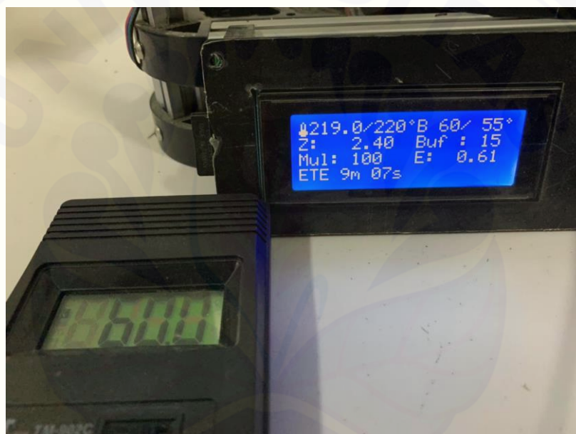
Gambar 10. Validasi suhu bed menggunakan termokopel
