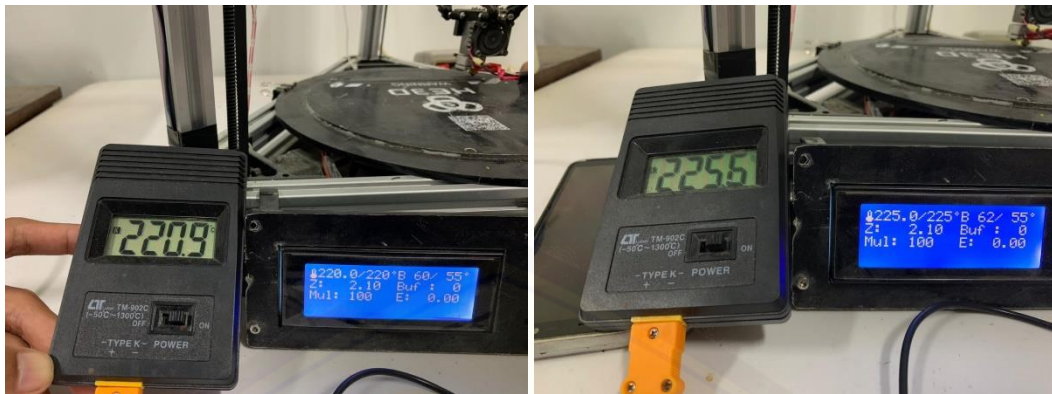
Gambar 9. Validasi suhu ekstruder menggunakan termokopel
