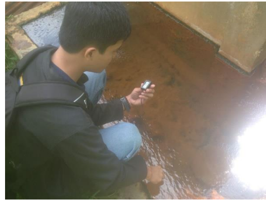
Gambar 6. Proses pengukuran temperatur di Mata Air Panas Blawan-Ijen, Jawa Timur
