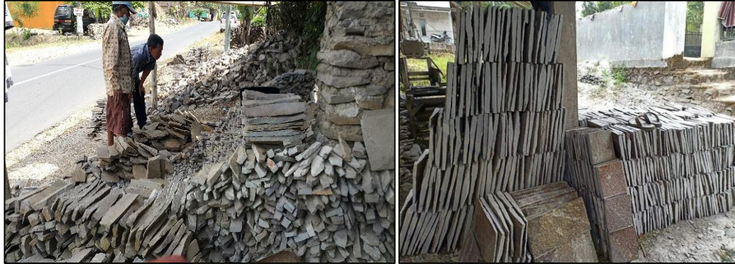
(a) Bentuk Batu Piring yang Dihasilkan Ukurannya Tidak Standar
