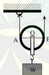
Gambar 2.16 Katrol bebas (Sumber: fisikazone.com)
