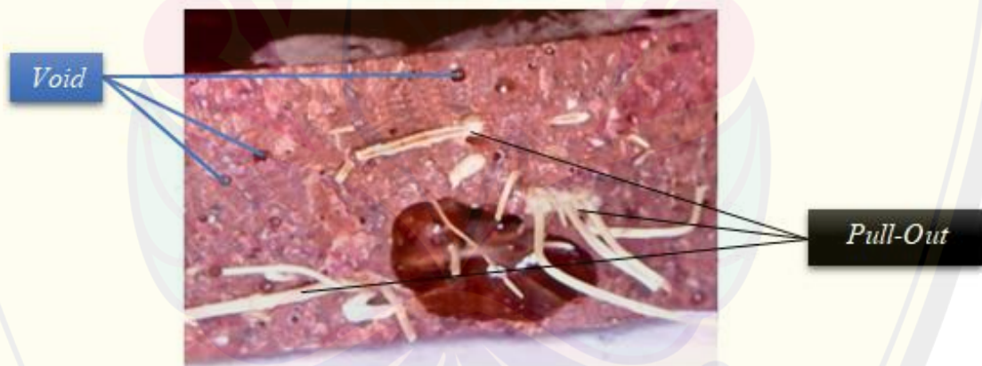
Gambar 4.18 Foto Mikro Spesimen Uji Tarik Fraksi Volume 50% Mortar
