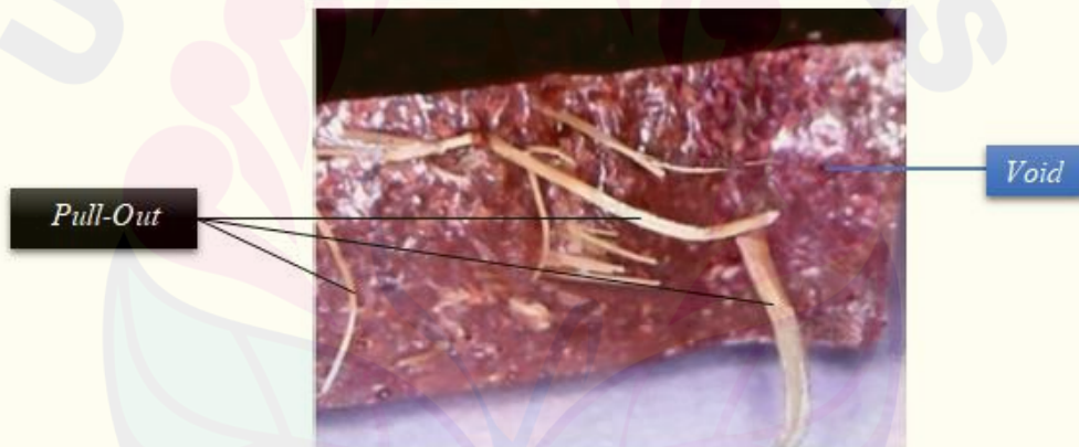
Gambar 4.16 Foto Mikro Spesimen Uji Tarik Fraksi Volume 30% Mortar
