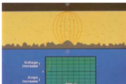
Gambar 2.1 proses EDM fase pertama
