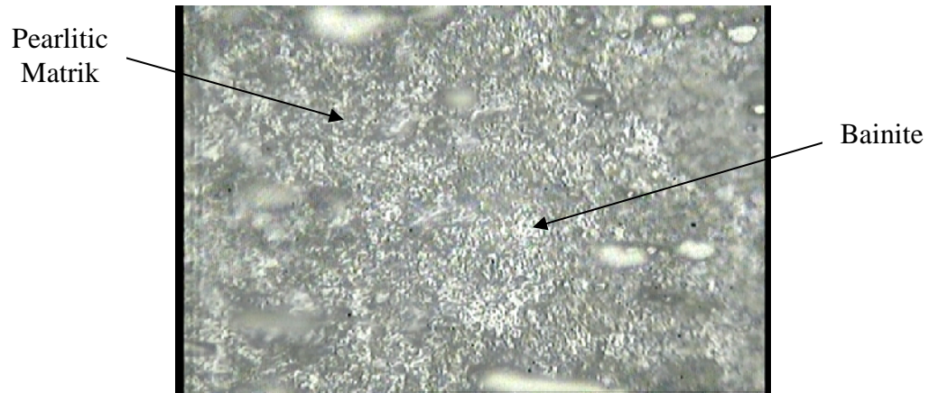
Gambar 4.5.a Struktur mikro HAZ dengan arus 15 ampere
