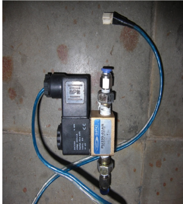
Gambar D.3. Katup solenoid
