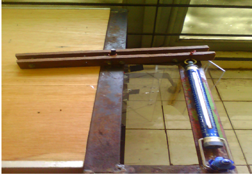
F.5 Gambar rangkaian prony break dengan pegas ukur
