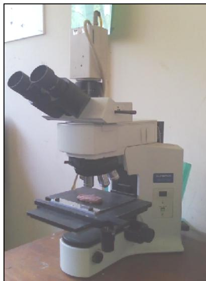
Gambar 3.5 Mikroskop Metalografi Olympus BX41M
