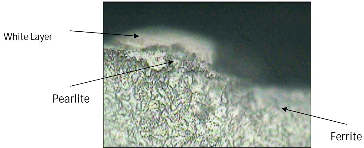
Gambar F.7 Struktur mikro baja karbon rendah tipe AISI H-13 pada titik terdekat proses yaitu pada titik 5 proses EDM dengan arus 9 A dan *on time* 90  $\mu$ s pada pembesaran 500 X
