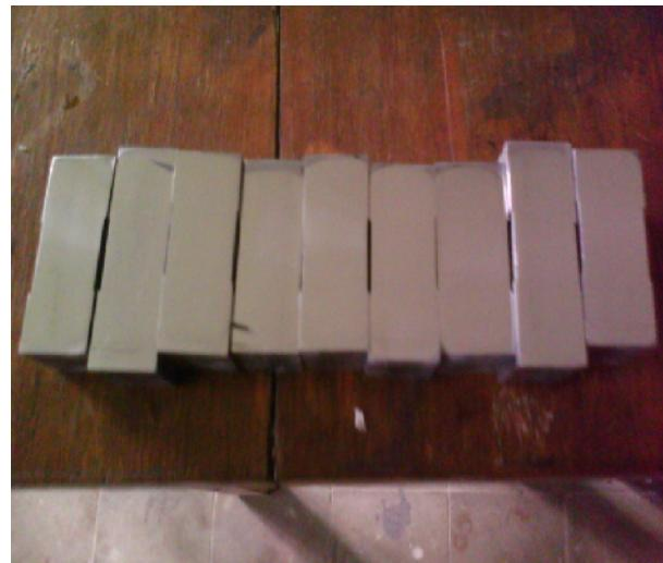
Gambar E 11. Baja AISI H-13 setelah di potong
