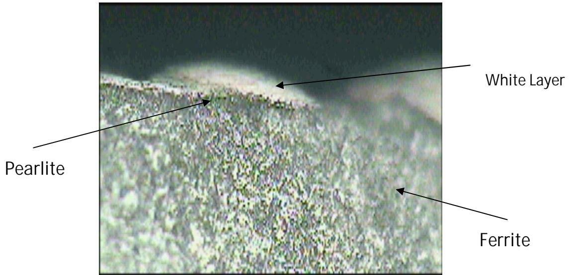
Gambar F.11 Struktur mikro baja karbon rendah tipe AISI H-13 pada titik terdekat proses yaitu pada titik 5 proses EDM dengan arus 9 A dan *on time* 150  $\mu$ s pada pembesaran 500 X
