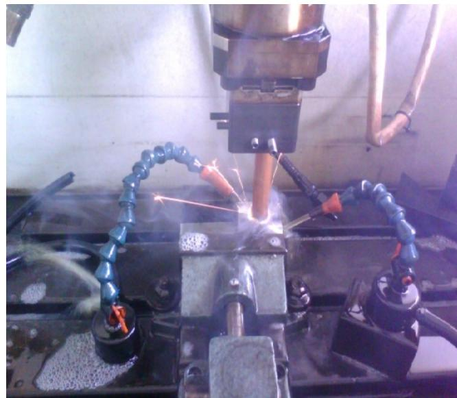
Gambar E.4 Proses penggeraan benda kerja dengan mesin EDM *Die Sinking*
