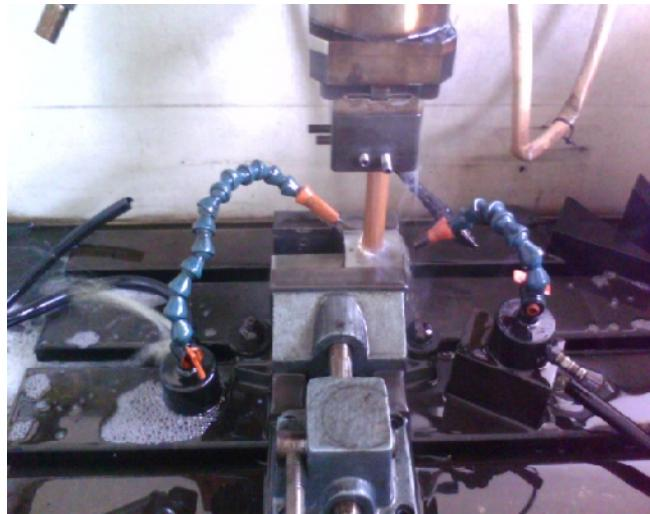
Gambar E.3 Proses penggeraan benda kerja dengan mesin EDM *Die Sinking*
