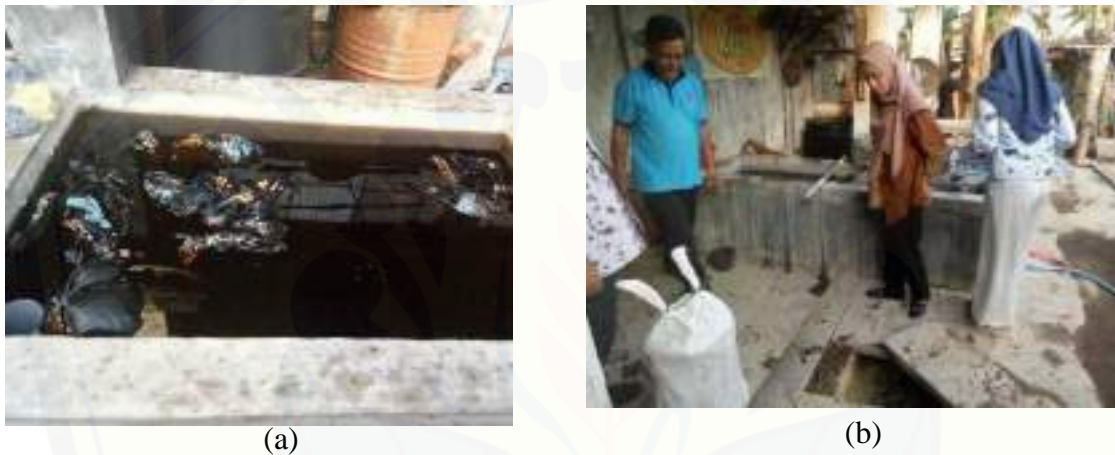
Gambar 1. Limbah Produksi Batik di Reztis Batik. (a) Limbah di Kolam Pencucian Batik, (b) Filtrasi Sederhana Menggunakan Ijuk dan Net Jaring
