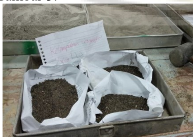
Gambar 2. Pengujian Kelembaban Agregat Halus
