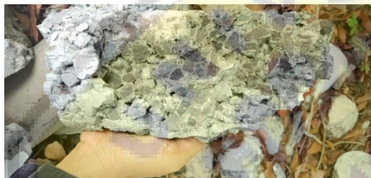
Gambar 11. Benda Uji Beton Berpori Setelah Pengujian Kuat Tekan
