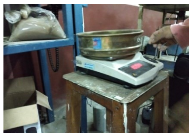
Gambar 3. Pengujian Analisa Saringan Agregat Halus
