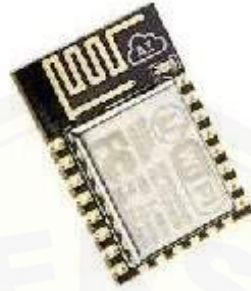
Gambar 2.1 Mikrokontroler Node MCU ESP8266 (Marhaenanto et al. , 2013)
