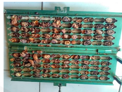
Gambar 19. Uji Belah Kering
