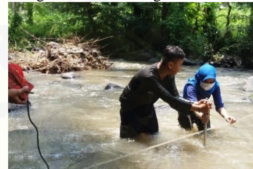
Pengambilan Sampel, pengukuran lebar sungai, dan pengukuran debit aliran (ATK03 dan ATK04)
