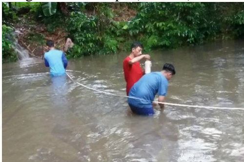
Pengambilan Sampel, pengukuran lebar sungai, dan pengukuran debit aliran (ATK03 dan ATK04)
