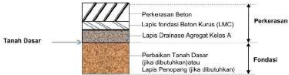
Gambar 2.2 Struktur Perkerasan Kaku
