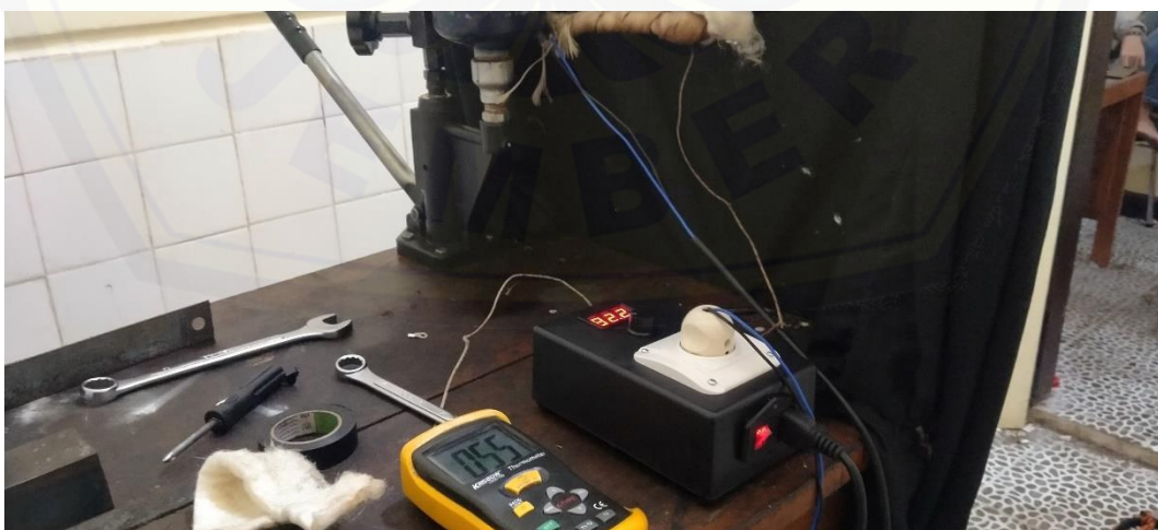
Gambar A.13 Skema Peletakan Heater dan Dimmer
