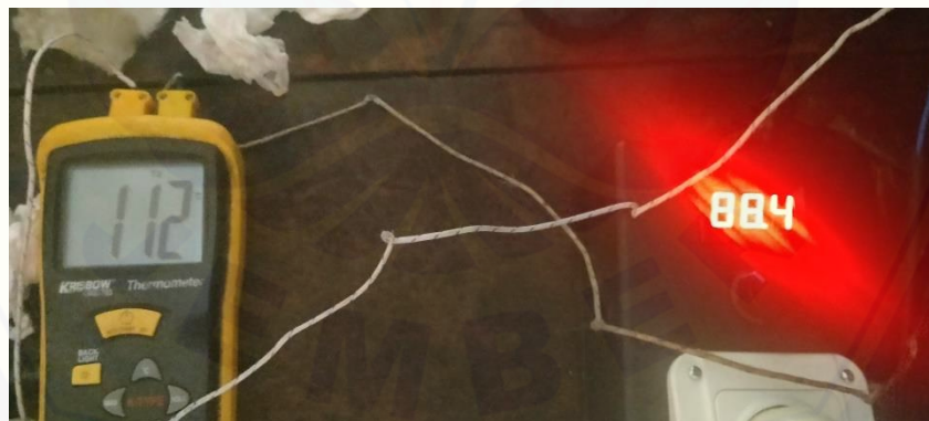
Gambar A.5 Pengaturan Temperatur Pemanasan 110°C
