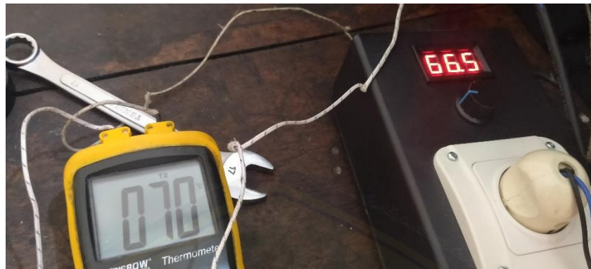
Gambar A.3 Pengaturan Temperatur Pemanasan 70°C
