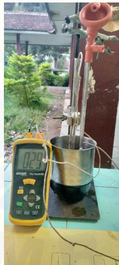
Gambar A. 10 Alat untuk mengukur viskositas
