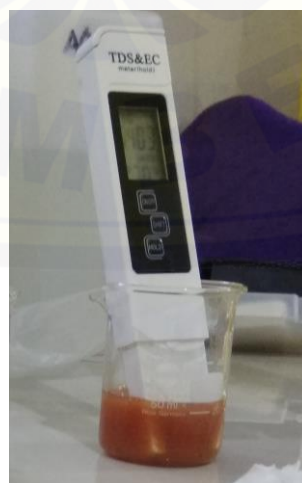
Gambar 3.5 TDS & EC meter (Sumber: Dokumen pribadi, 2020)
