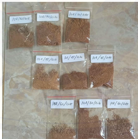
Gambar B. 5 Tatal Kayu Jati yang diperoleh dari Proses Bubut Variasi Kecepatan Putar Spindle 108 rpm dengan beberapa variasi sudut potong dan gerak makan.
