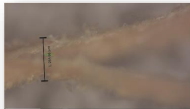
Keterangan Kecepatan putar spindle : 140 rpm Sudut potong : 45 Gerak makan : 0,15 mm/put Pembesaran mikroskop : 100x Ukuran total : 264,66 \mu\text{m}
