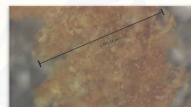
Keterangan Kecepatan putar spindle : 140 rpm Sudut potong : 45° Gerak makan : 0,30 mm/put Pembesaran mikroskop : 100x Ukuran tatal : 803,34 μm
