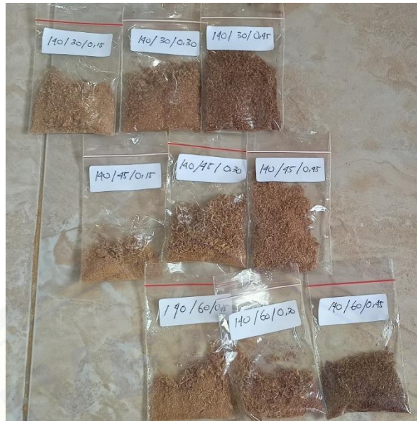
Gambar B. 6 Tatal Kayu Jati yang diperoleh dari Proses Bubut Variasi Kecepatan Putar Spindle 140 rpm dengan beberapa variasi sudut potong dan gerak makan.
