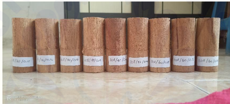
Gambar B. 2 Kayu Jati dengan Variasi Kecepatan Putar Spindle 108 rpm dengan beberapa variasi sudut potong dan gerak makan.
