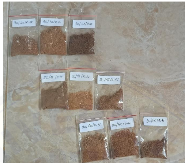
Gambar B. 4 Tatal Kayu Jati yang diperoleh dari Proses Bubut Variasi Kecepatan Putar Spindle 90 rpm dengan beberapa variasi sudut potong dan gerak makan.
