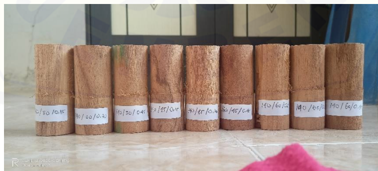
Gambar B. 3 Kayu Jati dengan Variasi Kecepatan Putar Spindle 140 rpm dengan beberapa variasi sudut potong dan gerak makan.
