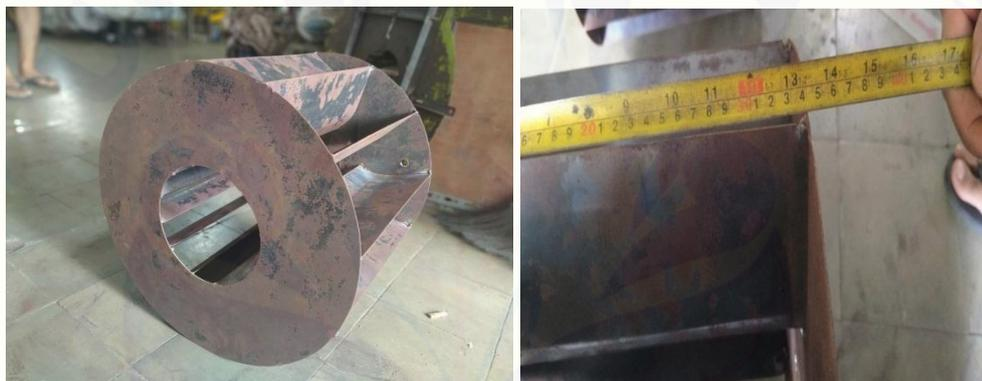
Gambar *Impeller* Lebar sudu 0,34 m
