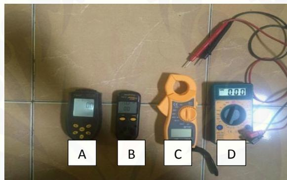
Gambar 3.3 (a) *Tachometer* (b) *Anemometer* (c) *Tang meter* (d) *Avo meter*
