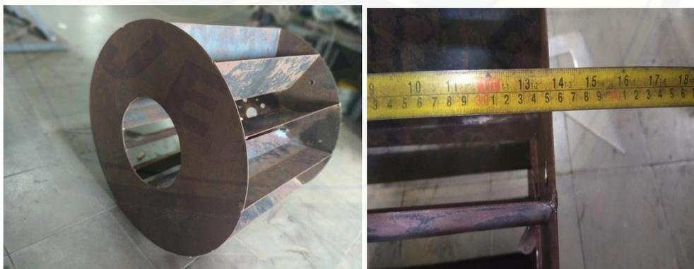
Gambar *Impeller* lebar sudu 0,35 m
