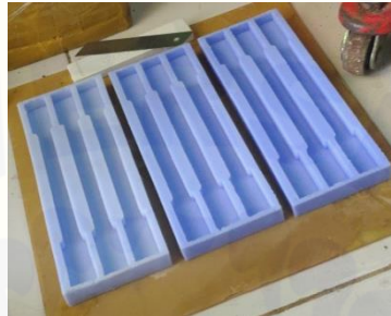
Gambar 3.1 Cetakan komposit berbahan silicon RTV 52
