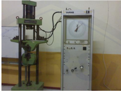
Gambar 3.4 Alat uji tarik merk Tarno Grocki 10 Ton
