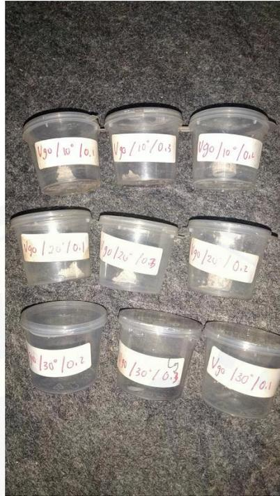
Gambar 11. Gram kaca pyrex yang diperoleh dari proses bubut variasi kecepatan putaran spindle 90 rpm dengan beberapa variasi sudut potong dan gerak makan
