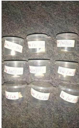
Gambar 9. Gram kaca pyrex yang diperoleh dari proses bubut variasi kecepatan putaran spindle 45 rpm dengan beberapa variasi sudut potong dan gerak makan
