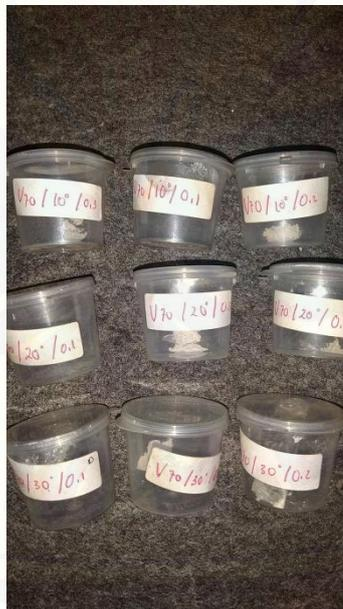
Gambar 10. Gram kaca pyrex yang diperoleh dari proses bubut variasi kecepatan putaran spindle 70 rpm dengan beberapa variasi sudut potong dan gerak makan
