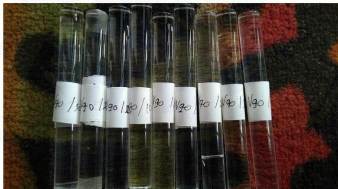
Gambar 8. Kaca Pyrex dengan Variasi Kecepatan Putaran Spindle 90 rpm dengan beberapa variasi sudut potong dan gerak makan.
