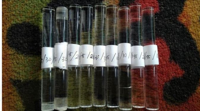
Gambar 6. Kaca Pyrex dengan Variasi Kecepatan Putaran Spindle 45 rpm dengan beberapa variasi sudut potong dan gerak makan.
