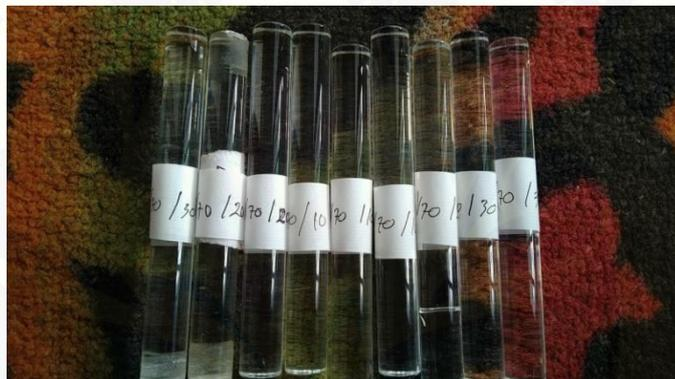
Gambar 7. Kaca Pyrex dengan Variasi Kecepatan Putaran Spindle 70 rpm dengan beberapa variasi sudut potong dan gerak makan.
