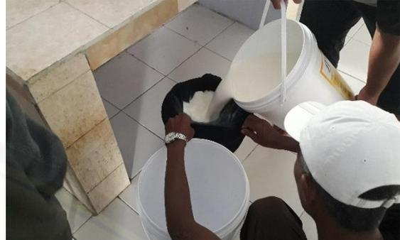
Gambar proses penyaringan
