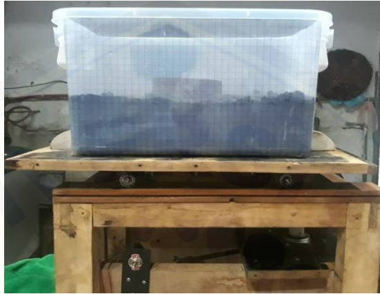
Gambar 2.3 Alat uji shaking table dengan pasir
