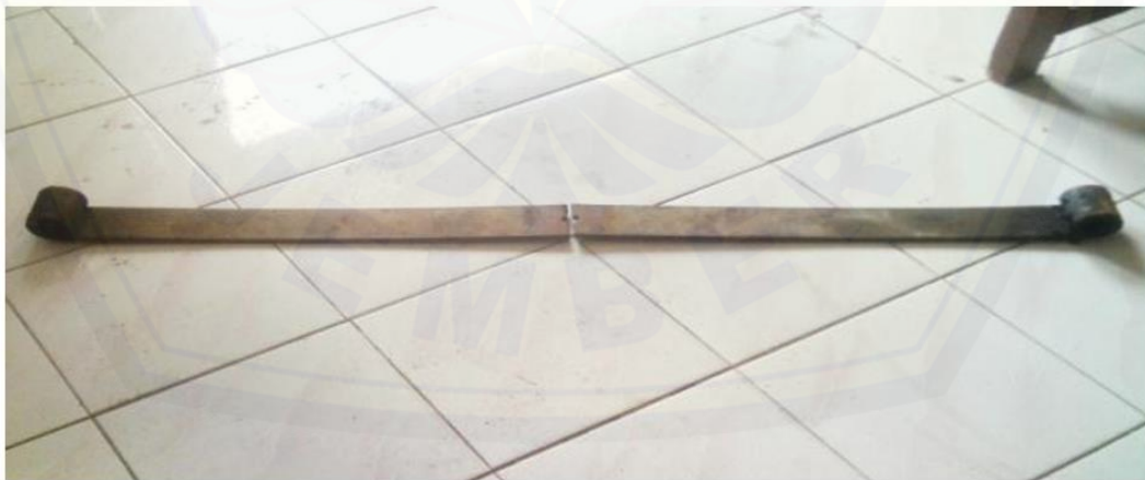
Gambar 2.1 Kegagalan Pada Leaf Spring Truk Colt Diesel (Sepitra, 2018)
