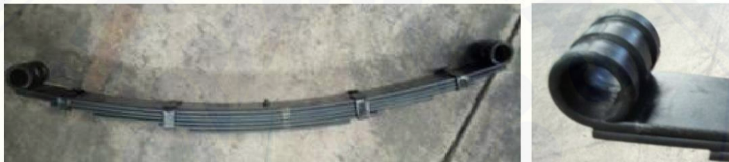
Gambar 2.3 Suspensi Pegas Daun Pada Kendaraan Roda 3 (Lukman, 2018)
