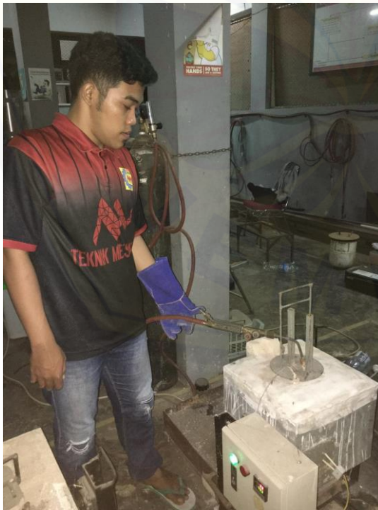
Proses Stir Casting dan Degassing
