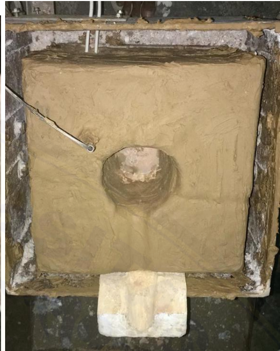
Pemasangan Tungku Pengecoran
