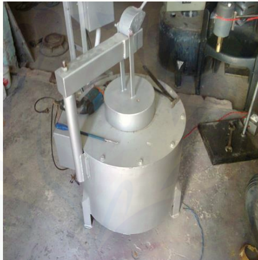
Gambar 2.7 Dapur Stir Casting (Kandpal, 2017)
