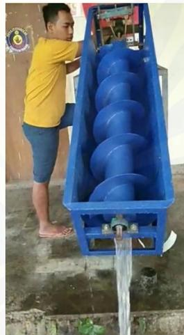
Gambar C.2 Proses Pengujian Screw Ketika Sudah Dikasih Sudut Kemiringan
