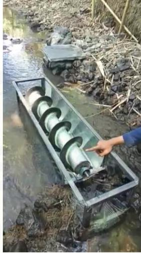
Gambar C.1 Proese Pengujian Screw di sungai
