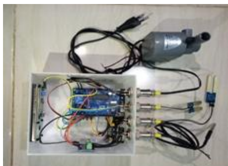
Gambar 1. Bentuk Sistem Fertigasi Rain Pipe Otomatis
