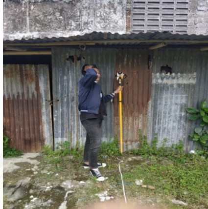
Gambar 30 Penembakan Titik Detail
