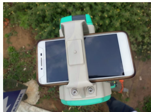
Gambar 29 Mencari Sudut Azimuth dengan Kompas
