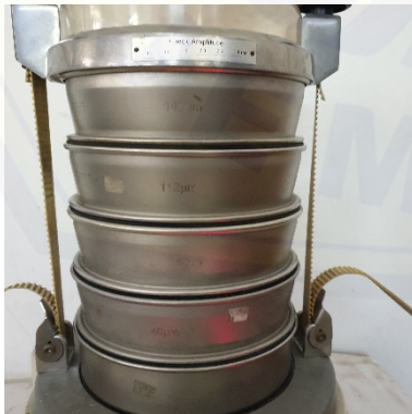
e. Mengayak serbuk limbah gigi hasil pencabutan menggunakan ayakan dan chieving machine Fritsch analysette 3 selama 30 menit.
