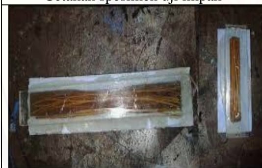
Proses pencetakan vraksi massa 2% serat
