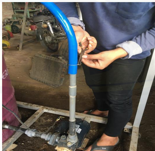
Gambar C.6 Pemasangan selang pada pompa
