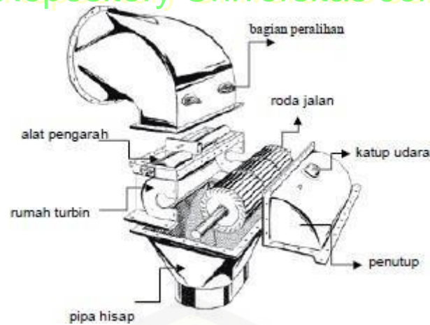
Gambar 2.3. Konstruksi dari Turbin Cross Flow (sumber: Dietzel & Sriyono, 1993)
