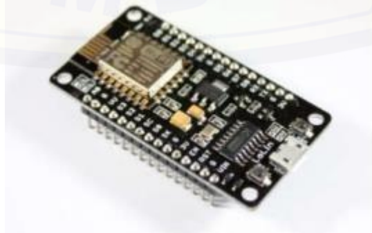
Gambar 2.4 ESP 8266 NodeMCU V3 (Sumber : probot.co.in )
