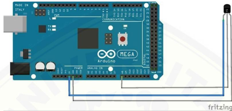
Gambar 3.7 Rangkaian Elektronika Sensor Suhu LM35
