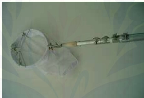
Gambar 2.1 Prototipe alat pemetik buah mangga (Suparlan et al. , 2006)
