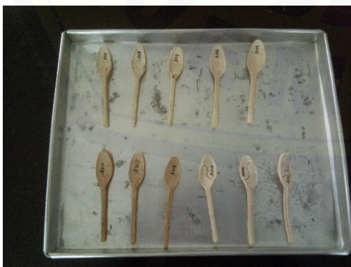
Gambar E.10 Persiapan uji kadar air
