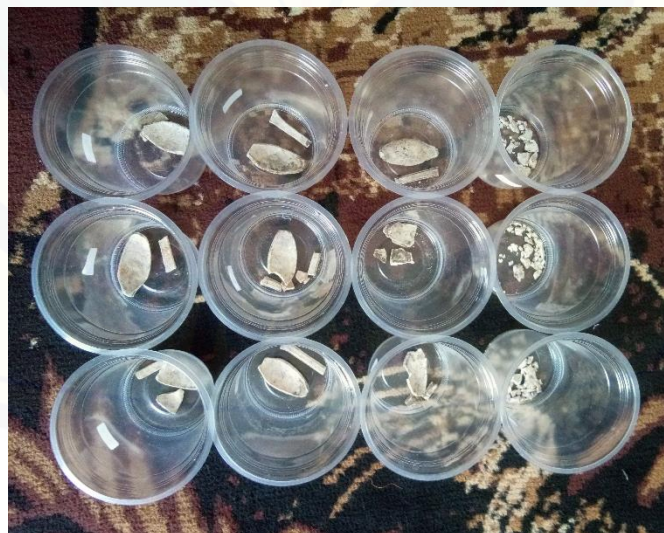
Gambar E.17 Sendok setelah uji biodegradasi
