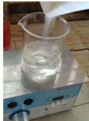
Proses Penambahan PVA Sesuai Fraksi Volume Pada Magnetic Stirrer
