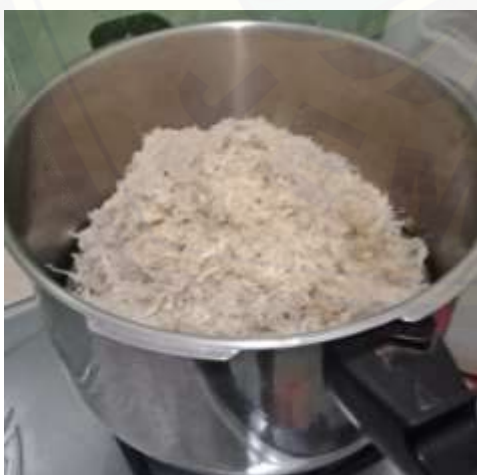
Proses Pelunakan Serat Menggunakan Presto
