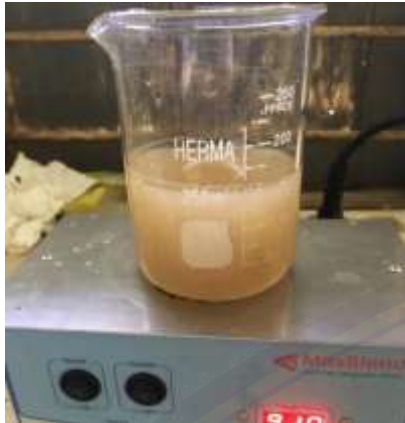
Proses Homogenisasi Menggunakan Magnetic Stirrer
