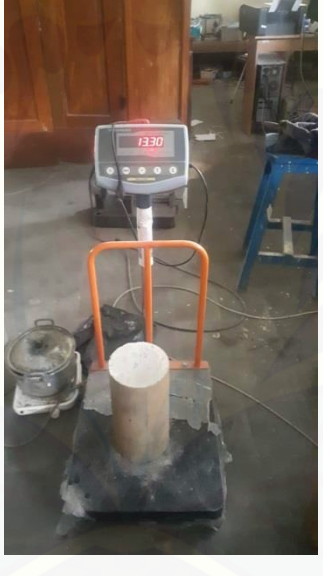
Lampiran B.8 Foto Kegiatan Menimbang Benda Uji
