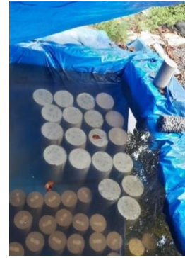
Lampiran B.7 Foto Benda Uji yang Sudah Dilepas Kemudian Direndam dalam Kolam
