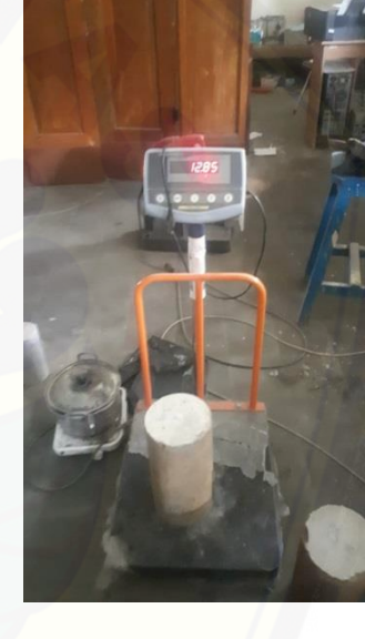
Lampiran B.8 Foto Kegiatan Menimbang Benda Uji
