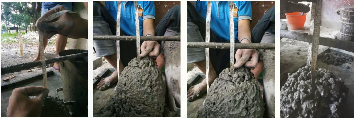
Lampiran B.6 Foto Pengujian Nilai Slump
