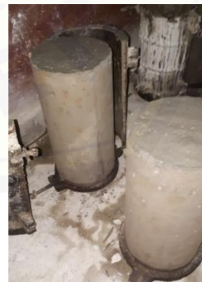
Lampiran B.6 Foto Kegiatan Melepaskan Benda Uji dari Bekesting
