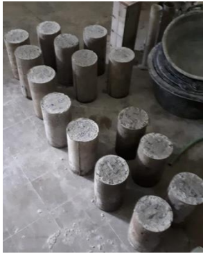
Lampiran B.7 Foto Benda Uji yang Sudah Dilepas Kemudian Direndam dalam Kolam
