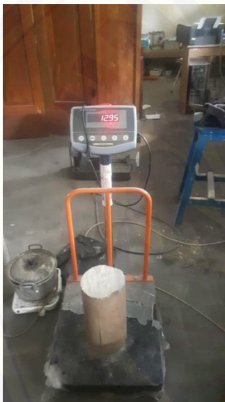
Lampiran B.8 Foto Kegiatan Menimbang Benda Uji
