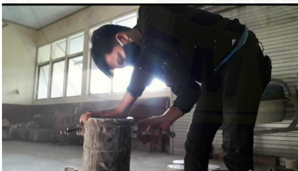
Lampiran B.6 Foto Kegiatan Melepaskan Benda Uji dari Bekesting
