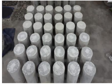
Lampiran B.7 Foto Benda Uji yang Sudah Dilepas Kemudian Direndam dalam Kolam
