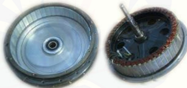
Gambar 2.1 Rotor Dan Stator Motor BLDC
