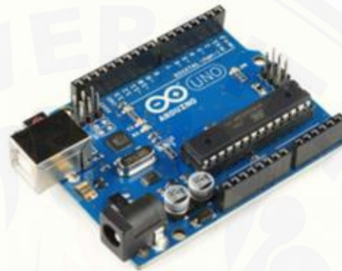
Gambar 2.11 Arduino Uno R3
