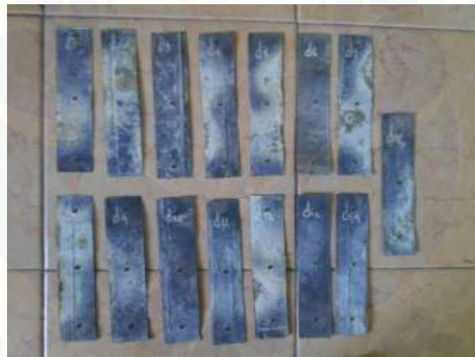
Gambar D.4 Pengamatan struktur makro spesimen dengan pembagian tiga anoda korban (D)
