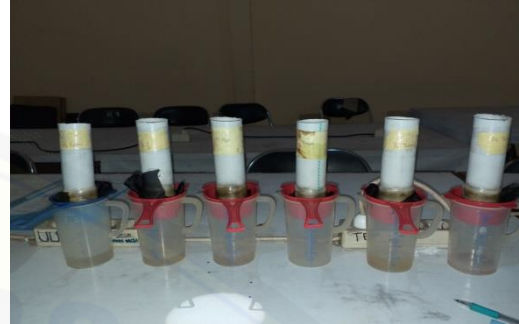
Proses pengujian permeabilitas tanah
