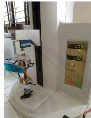
Pengukuran kuat tarik dan elongasi edible film
