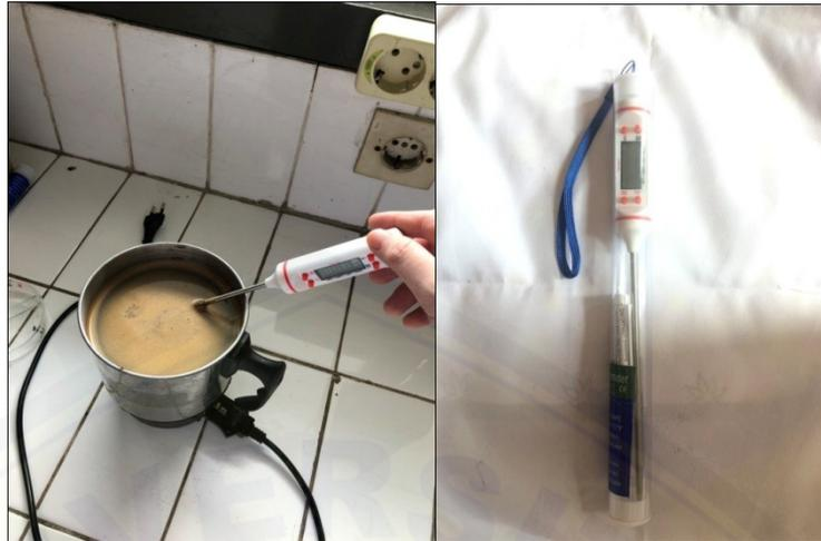
Gambar 3.11 Proses menghomogenkan pada Suhu 60°C Menggunakan Thermometer Kopi Digital (Sumber: Dokumentasi Pribadi)
